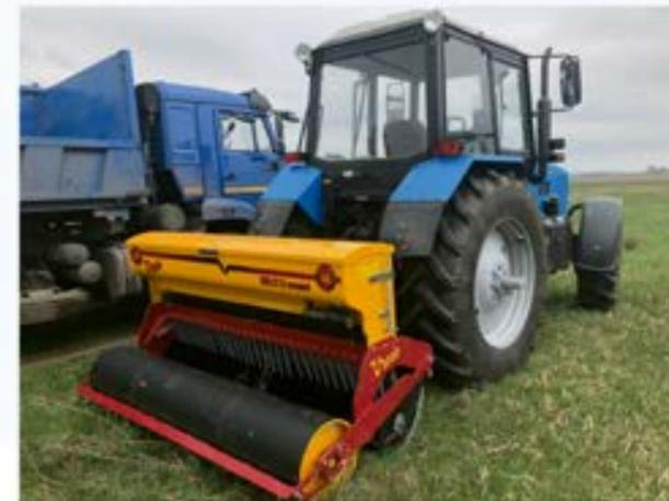
Два V-образных диска делают узкий разрез в дернине. Семя падает через V-образные диски в разрез на точно установленную глубину.
