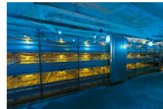
Рис. 2. Клеточная батарея для выращивания цыплят-бройлеров с роботизированной выгрузкой птицы на убой
