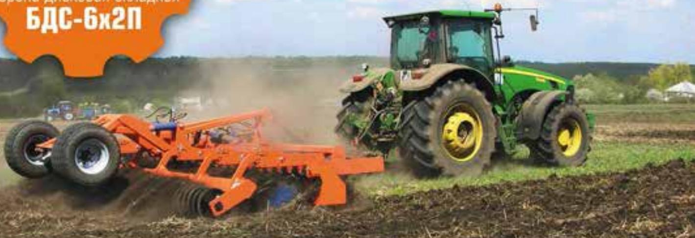
Борона дисковая складная полупротяженная БДС-6х2П предназначена для традиционной, минимальной основной и предпосевной обработки почвы под зерновые, технические и кормовые культуры, освежения задернелых лугов, пущения стерни и рекультивация паров.
