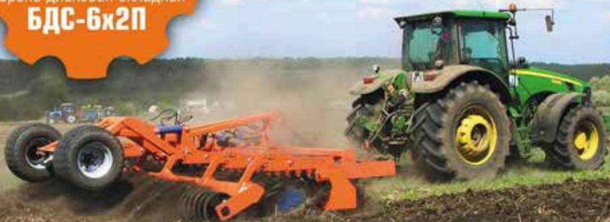
Борона дисковая складная полуприцепная БДС-6х2П предназначена для традиционной, минимальной основной и предпосевной обработки почвы под зерновые, технические и кормовые культуры, освежения задерненных лугов, лущения стерни и рекультивация паров.
