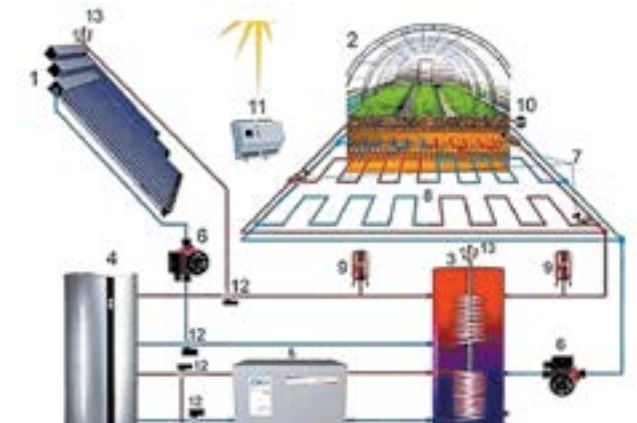
Рисунок 2. Сушка сельскохозяйственных культур с помощью солнечного коллектора.
