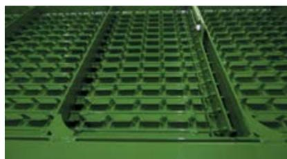
Все решета имеют полимерно-порошковое покрытие (не оцинковку). Лучшая защита от коррозии металла. На гладком покрытии не происходит налипания влажной массы. Толщина полимера 220–250 микрон (оцинковка 13–18 микрон).
