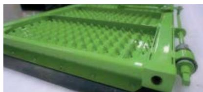
Рама решет выполнена из гнущего профиля (толщина от 1,5 до 6 мм. в зависимости от модели комбайна). При изготовлении используются разработанные нашей компанией различные технические решения, для улучшения прочностных характеристик.
