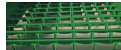
Это небольшой элемент гребенки, который выполняет две функции: сдерживание попадания крупных фрагментов массы после обмолота и образование «воздушного флажка» на выходе воздушного потока за гребенку. Названные достоинства позволяют эффективно использовать воздушный поток от вентилятора комбайна. Оптимальный результат очистки обеспечивается при умеренной мощности вентилятора.
