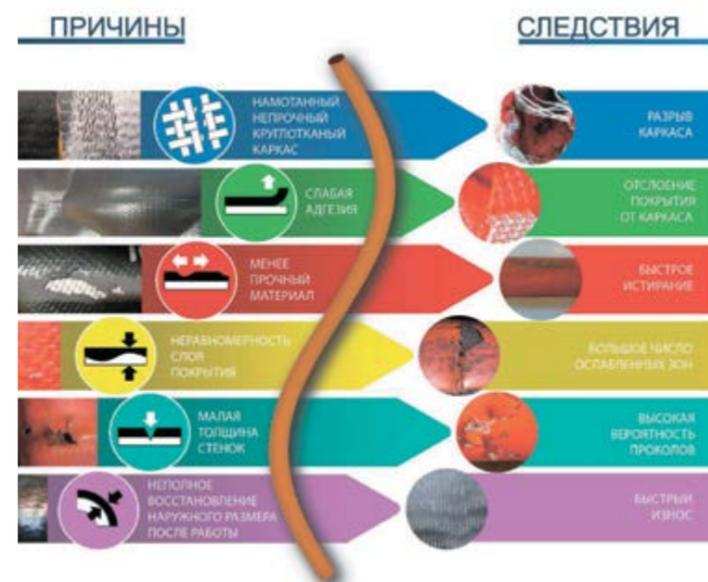
Следует отметить, что в отличие от давления разрыва и предела прочности на разрыв (для которых справедлив тезис: чем больше – тем лучше), большая толщина шлангов предполагает и определенные минусы: чем толще стенки, тем больше объем, а следовательно, меньшую длину можно уместить на одной катушке. Таким образом, толщина стенок должна быть оптимальной: не слишком малой, чтобы не потерять в надежности, но и не слишком большой, чтобы не столкнуться с дополнительными эксплуатационными расходами.
