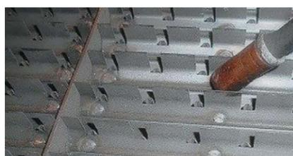
На производстве применяется технология сварки в защитной среде. Для улучшения прочностных характеристик крепления гребенки к спице, выбран оптимальный сварной шов равный в среднем 12 мм с пошаговым интервалом 70 мм.
