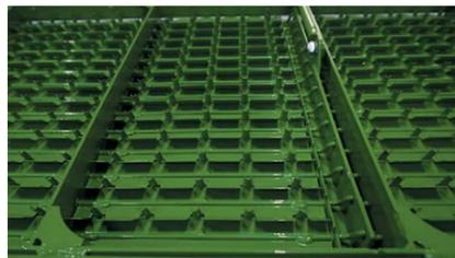
Все решета имеют полимерно-порошковое покрытие (не оцинковку). Лучшая защита от коррозии металла. На гладком покрытии не происходит налипания влажной массы. Толщина полимера 220–250 микрон (оцинковка 13–18 микрон).
