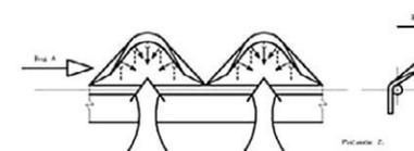
К тому же зуб имеет форму конуса, поэтому воздух, проходящий под ним, сжимается на выходе, создавая завихрения.
