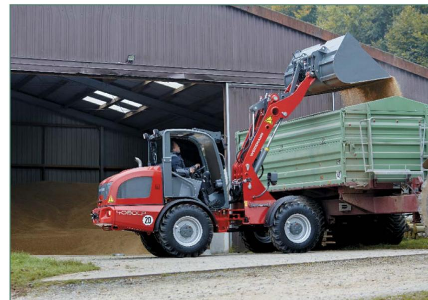
нескольким стандартам – защита от опрокидывания и от падающих объектов. Поэтому все модели 11–17-й серий погрузчиков Hoftrac серийно оснащаются фиксированной защитной крышей. Однако, как показывает практика, если необходимо проехать через проемы ниже двух метров, то тут фиксированная защитная крышка
