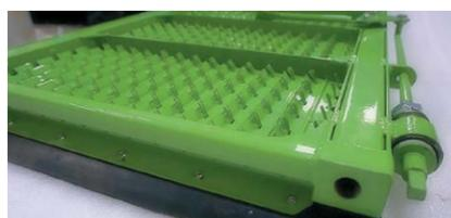
Рама решет выполнена из гнущего профиля (толщина от 1,5 до 6 мм. в зависимости от модели комбайна). При изготовлении используются разработанные нашей компанией различные технические решения, для улучшения прочностных характеристик.
